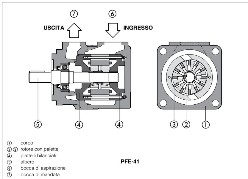
Le pompe PFE-\*1 sono pompe a dodici palette (2) (3) a cilindrata fissa, costruzione a cartuccia con bilanciamento idraulico integrale (4) per funzionamento ad alta pressione, con lunga vita funzionale e con basso livello sonoro.
